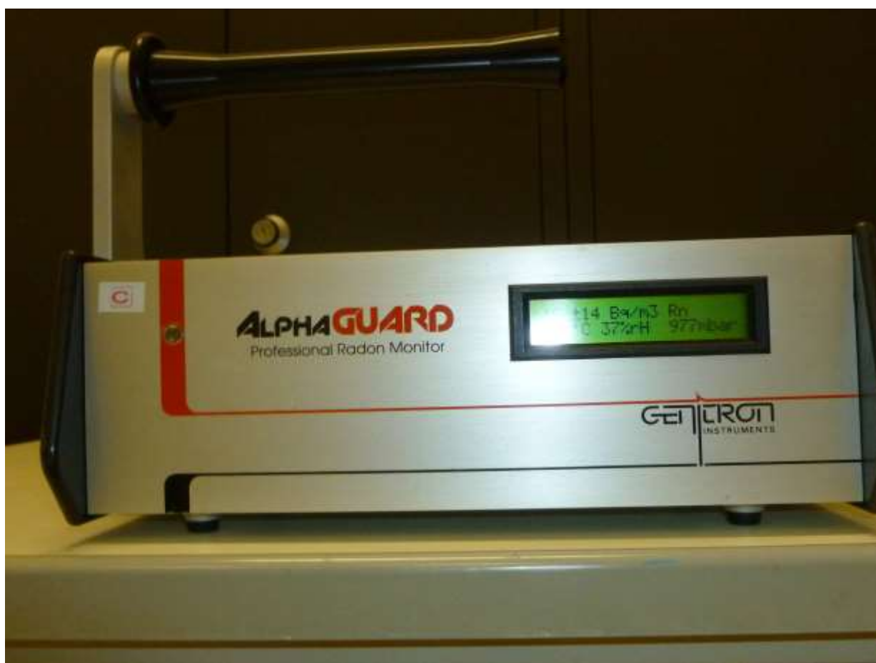
Figure 1 : Photographie d'un appareil électronique pour mesurer le radon dans l'air du type Alphaguard
