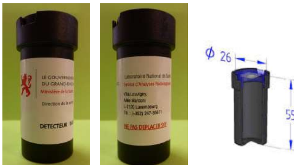
Figure 1 : Vue de profil et coupe schématique de l'exposimètre radon
