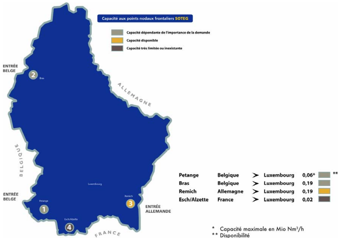
Abbildung 29 Einspeisepunkte für die Erdgasversorgung Luxemburgs
